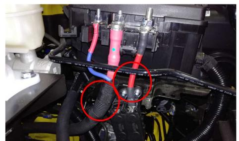
Kann die 12 Volt Batterie nicht abgeklemmt werden, sind die Rückhaltesysteme weiterhin aktiv!
